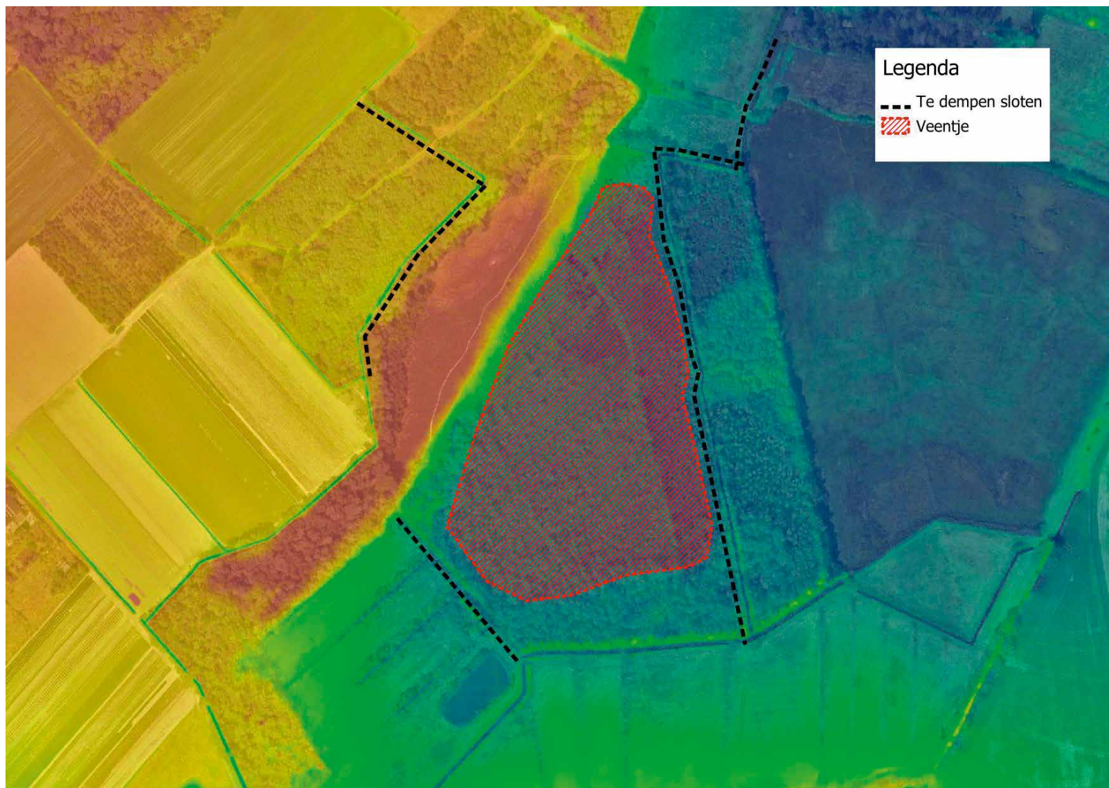
Figuur 6. Voorbeeld van geplande hydrologische maatregelen in een deelgebied van Lange Gooren, geprojecteerd op de hoogtekarta (rood= hoog, blauw= laag). Drainerende sloten (- -) rond een veentje worden gedempt.
