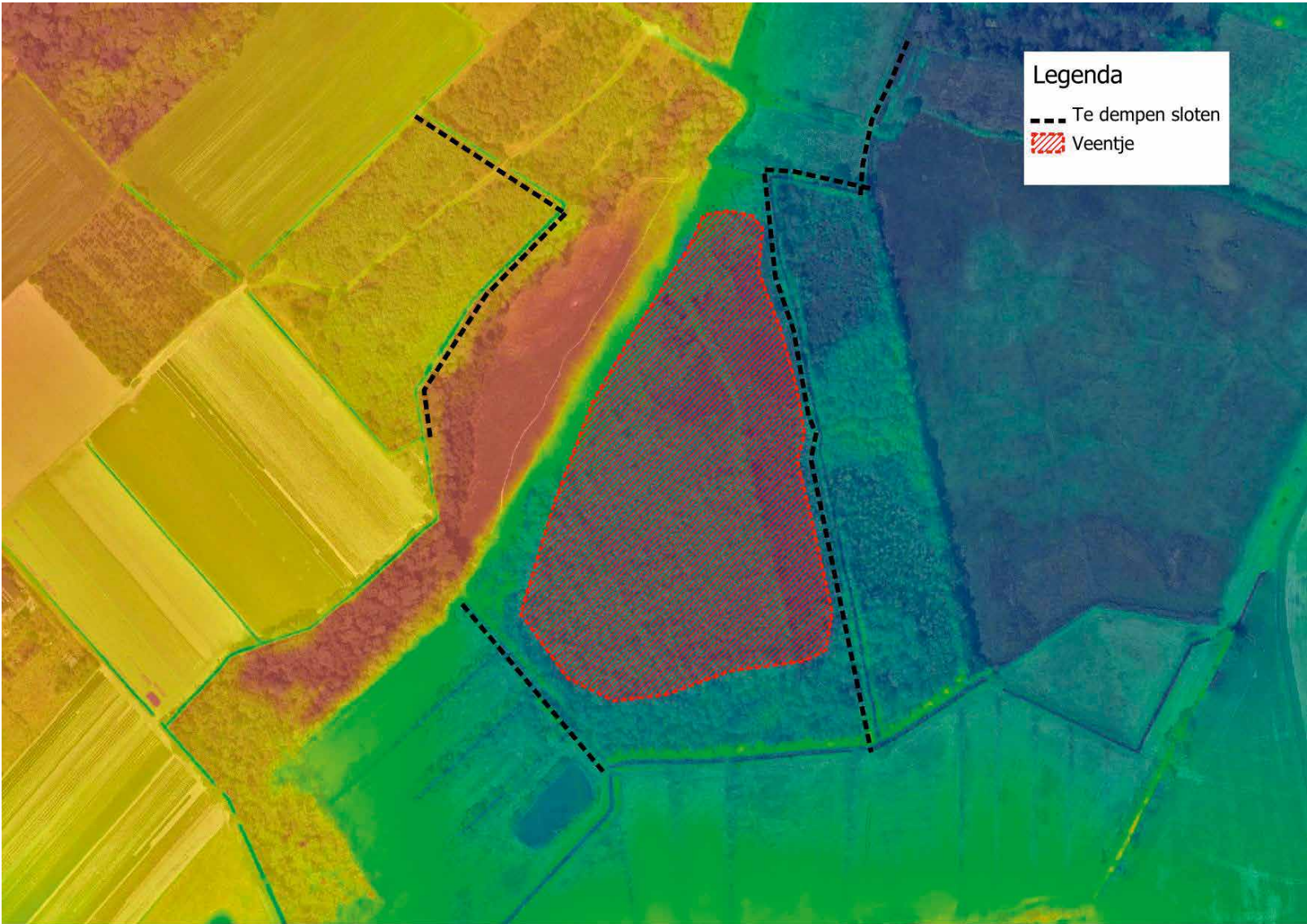
Figuur 6. Voorbeeld van geplande hydrologische maatregelen in een deelgebied van Lange Gooren, geprojecteerd op de hoogtekaart (rood= hoog, blauw= laag). Drainerende sloten (- -) rond een veentje worden gedempt.
