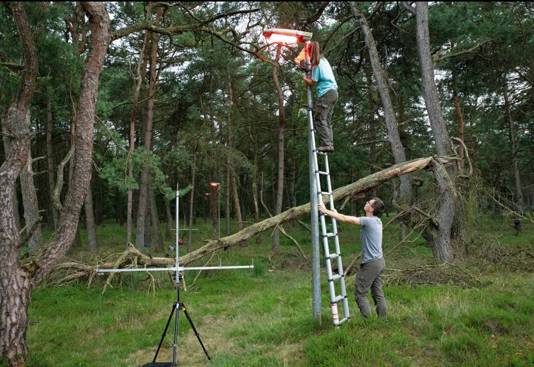
Onderzoekers bezig met het plaatsen van apparatuur om de aanwezigheid van vleermuizen en insecten te meten in de buurt van de experimentele lantaarnpalen.
